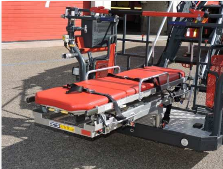
Photo 72A9 : Système de fixation du brancard sur une plateforme d'EPC
